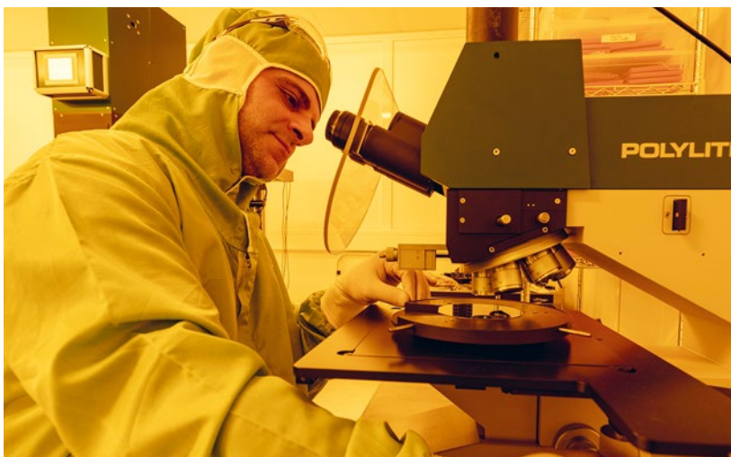
Im Reinraum: Qualitätskontrolle von fotolithografischen Nanostrukturen auf einem Silizium-Wafer.
