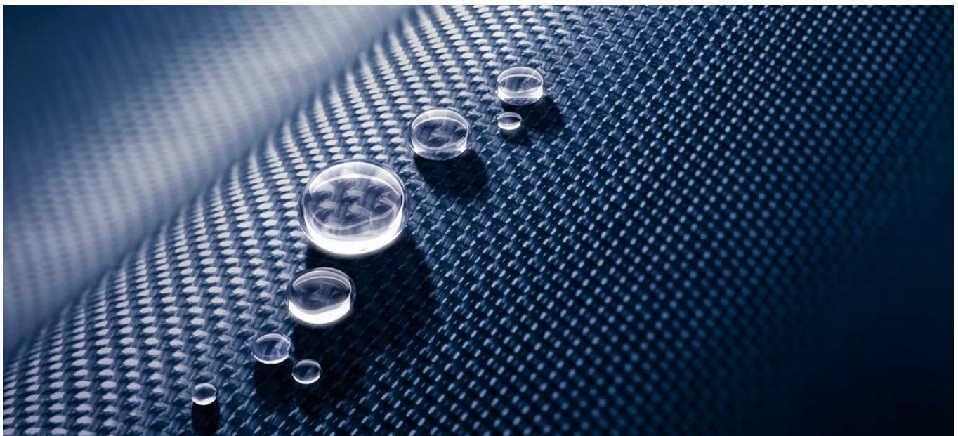
Stehende Wassertropfen auf einer nanobeschichteten hydrophoben Textiloberfläche für vielfältige Anwendungen.
