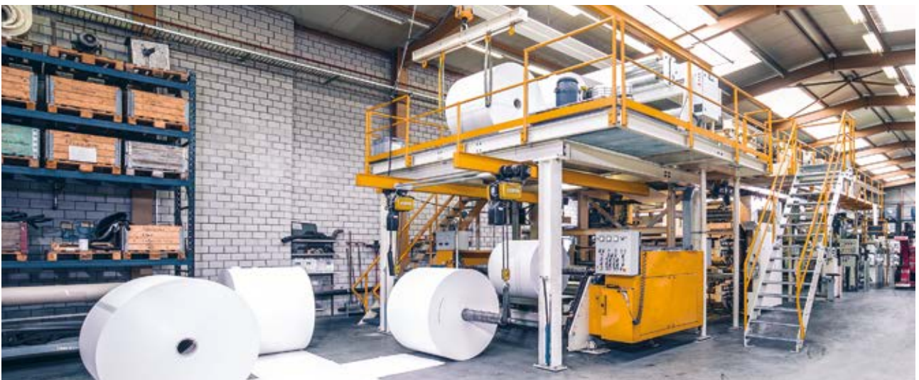
Auf dieser Anlage wird der Spezialkarton beschichtet, sodass er rutschhemmend wird.
