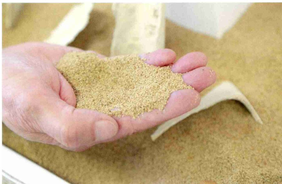
Das beigemischte Granulat aus Nusschalen trägt den Kalk ab.
