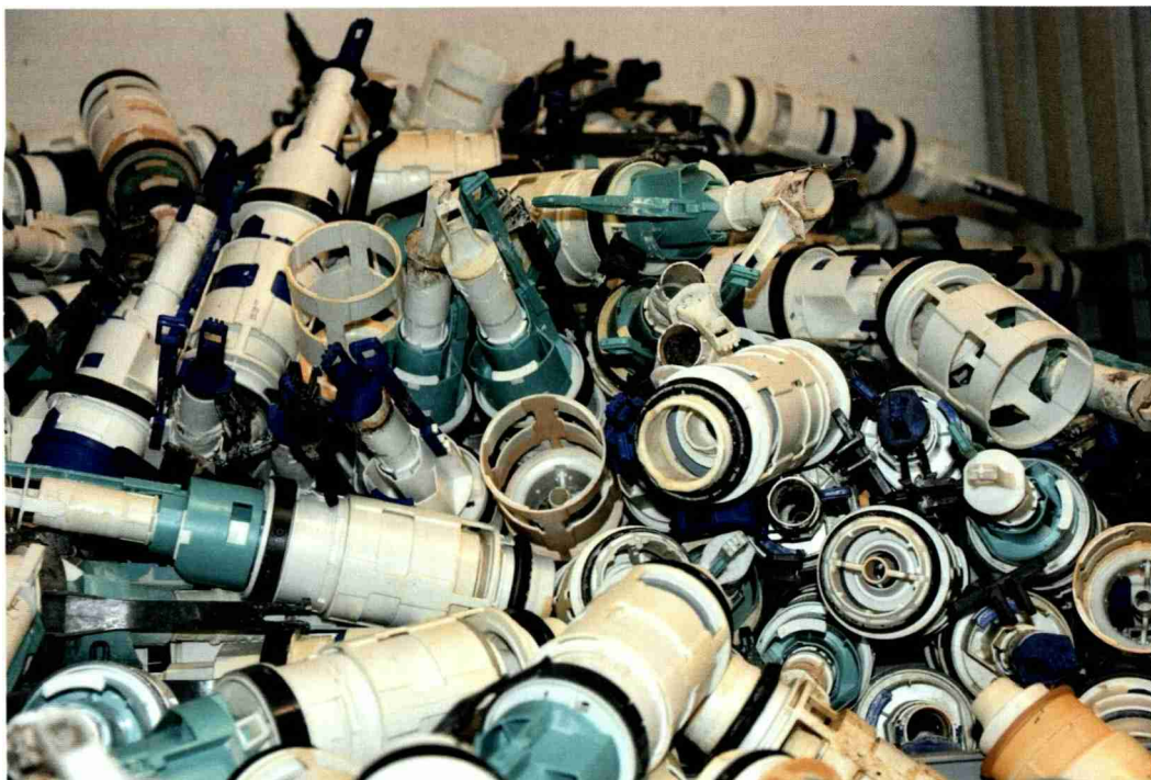
Die stark verschmutzten Spülsystemteile ...
