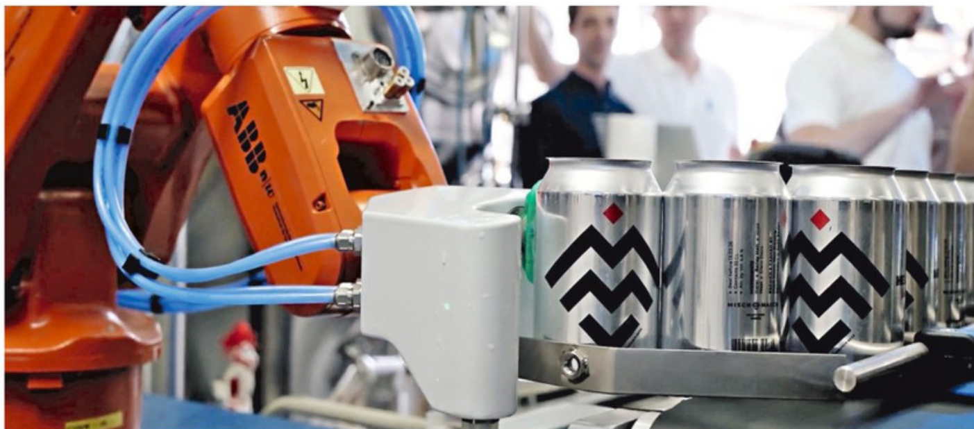
Der robotergesteuerte Dosengreifer wurde in der Badener Kleinbrauerei Mischmasch getestet.
